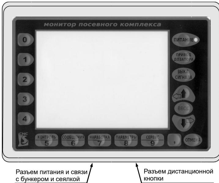
Рисунок 2.3. Монитор (вид спереди)
