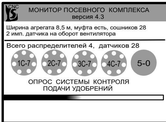
Рисунок 4.5. Конфигурация системы контроля высева семян
