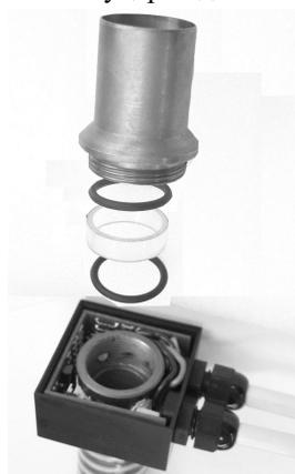
Рисунок 8.4: Разборка датчика потока
