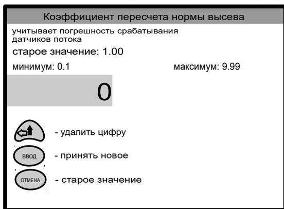
Рисунок 4.24. Окно редактирования коэффициента пересчета нормы высева
