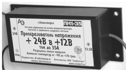
Рисунок 2.1. Внешний вид преобразователя напряжения
