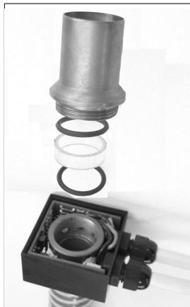
Рисунок 7.3: Разборка датчика потока
