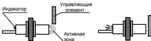
Рисунок 2.6. Работа датчика вращения
