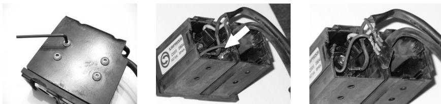
Рисунок 7.1. Разборка замка зажигания для доступа к предохранителю
