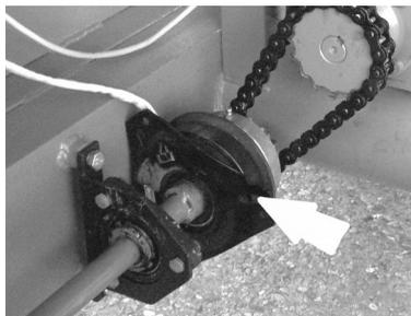
Рисунок 2.13. Муфта привода вала дозатора
