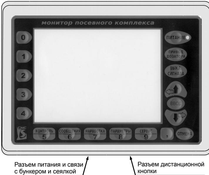
Рисунок 2.3. Монитор (вид спереди)
