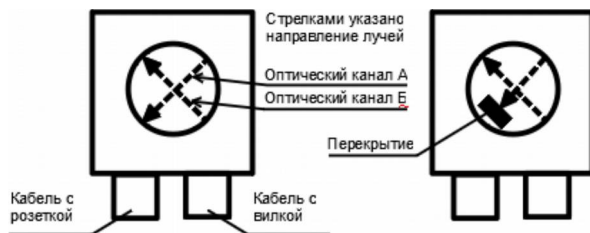
Рисунок 6.2: Расположение оптических осей и вариант перекрытия
