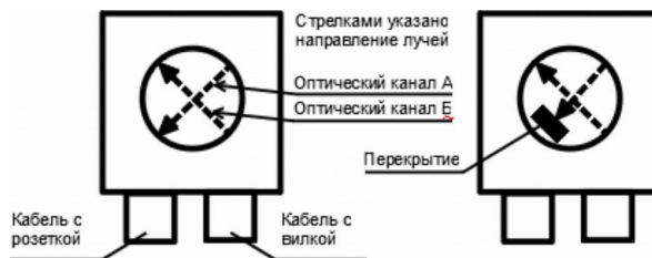
Рисунок 6.2: Расположение оптических осей и вариант перекрытия
