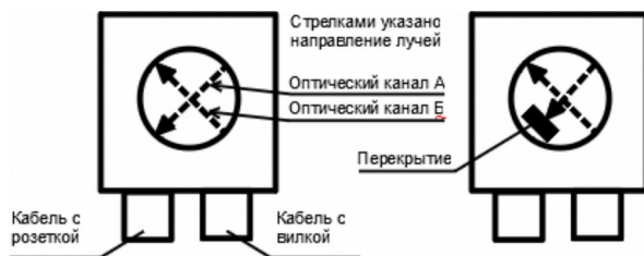
Рисунок 7.2: Расположение оптических осей и вариант перекрытия
