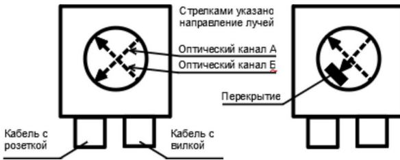
Рисунок 7.2: Расположение оптических осей и вариант перекрытия
