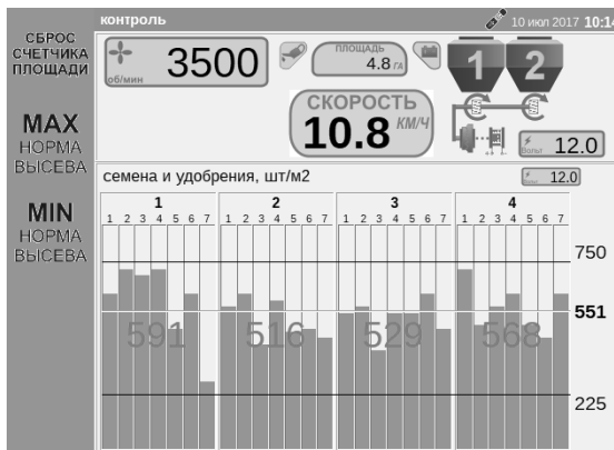
Рисунок 4.1. Диаграмма распределения семян по семяпроводам
