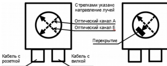
Рисунок 7.2: Расположение оптических осей и вариант перекрытия
