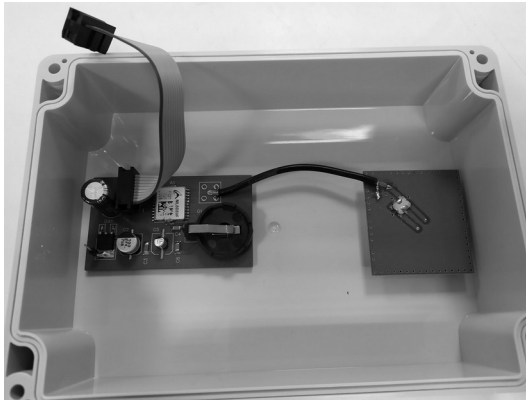
Рисунок 2.1. Плата приемника и антенна на крышке
