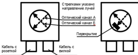
Рисунок 7.2: Расположение оптических осей и вариант перекрытия
