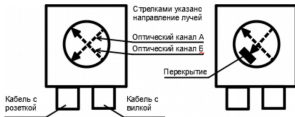
Рисунок 7.2: Расположение оптических осей и вариант перекрытия
